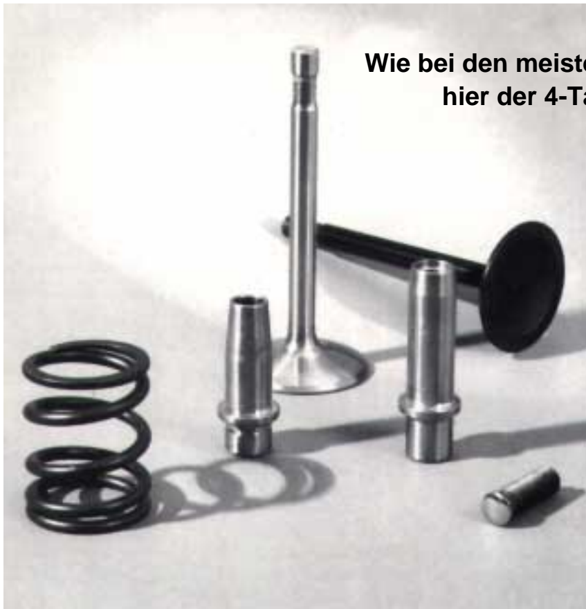
Diverse Komponenten wie Chromschachtventil, Ventil aus Nitrierstahl, Einlass- (kurz) und Auslass-Führung, progressive V-Feder und Radius-Einstellteller
