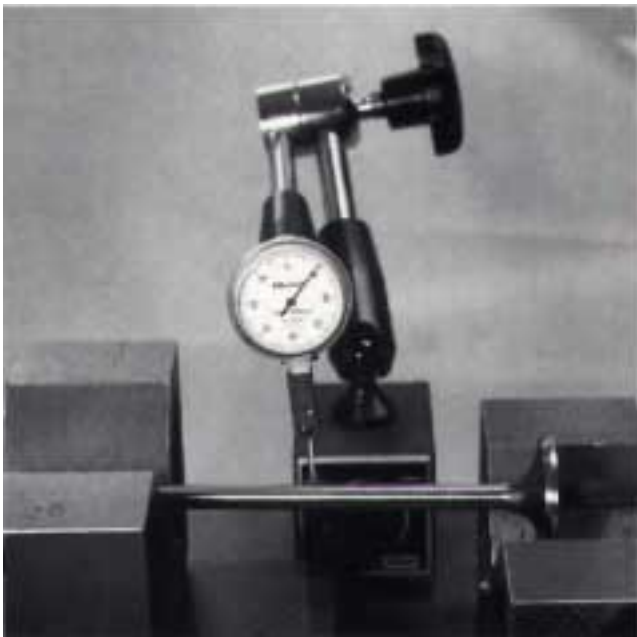
Ventilschaft-Prüfung auf Prismen
