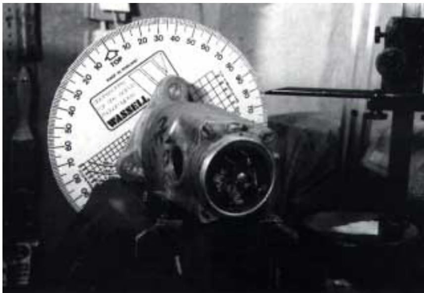
Magnet mit Gradscheibe im Schraubstock, rechts der Zeiger
