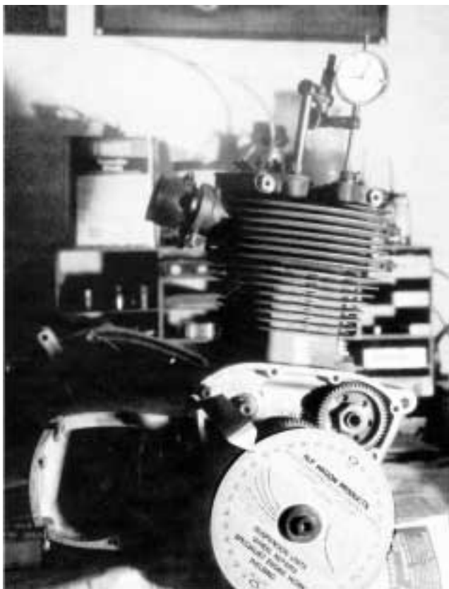
Gradscheibe und Messuhr an einem Triumph-Motor angebracht
